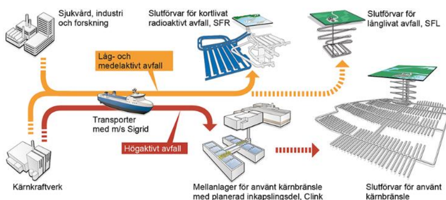
Rysunek 5. Istniejący system postępowania z odpadami promieniotwórczymi i zużytym paliwem jądrowym. Niebieskie tunele skalne w SFR, zakład kapsułkowania obok Clab i SFL oraz końcowe składowisko zużytego paliwa jądrowego to obiekty, które pozostają do wybudowania (Svensk Kärnbränslehantering AB).
